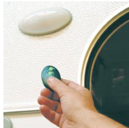
Utvendig belysning med bevegelsesvakt X0213 Fjernstyrning X0159
