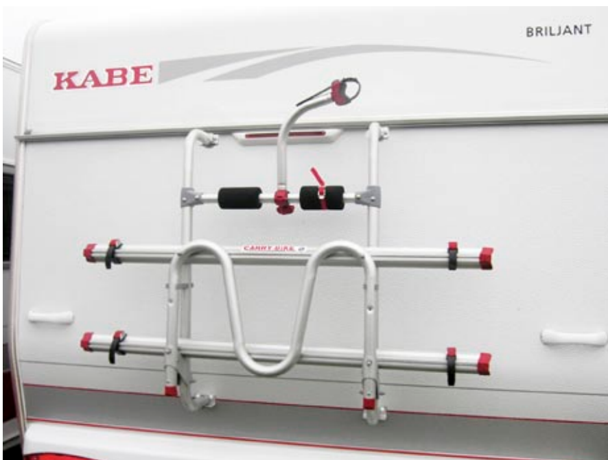
Sykelholder X0061 Monteres på baggavlen. Tåler vekt opp til 50 kg (2 sykler). Skvettlapp bak hjulpar. X0088
