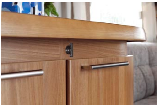
Sentrallås hindrer at låsene går opp under kjøring.
