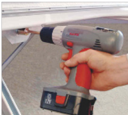
Elektrisk støttebensveiv X0202 Erstatter manuell støttebensveiv. 19 mm pipe medfølger.
