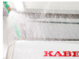
Sadekammiossa matkailuvaunujen päälle ruiskutetaan vettä kovalla paineella.
