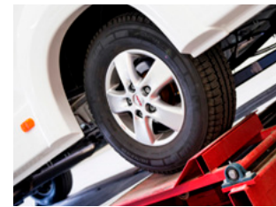
Kestävyttä simuloidaan täristyspenkissä kokeessa, joka vastaa 100 000 kilometrin normaalia ajoa.
