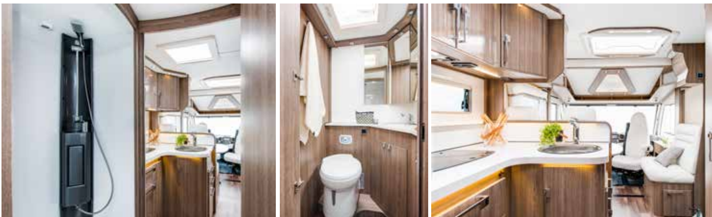
TMI 860 med bad og toiletrum på hver siden af midtergangen.
