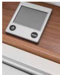
Uusi alde-lämmitin 3020, ohjauspaneeli oven yläpuolella
