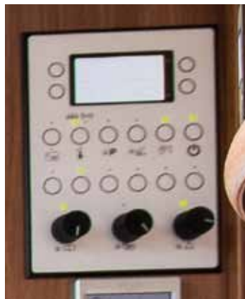
Elpanel med alle funktioner samlet
