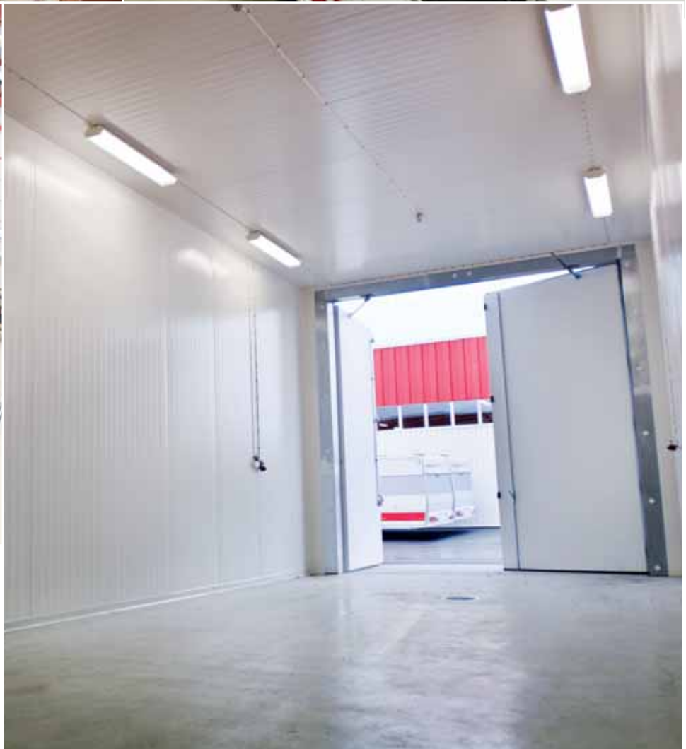
Mikael Blomqvist, teknisk sjef på KABE viser det enorme kuldekammeret som er unikt i bransjen; her testes både campingvogner og bobiler - til og med den 11 meter lange Haciendaën får plass - i -30° og opp til +55°. Øverst; 4 individuelle spor finnes fast montert i gulvet. I regnkammeret besprutes vognene og bilene med samme densitet som ordentlig regn.
