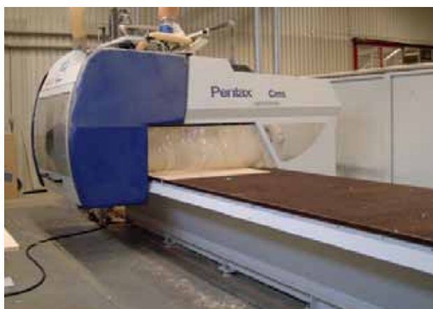
In zeven computergestuurde freesmachines krijgen de verschillende onderdelen hun vorm. Gemiddeld arriveren er elke week twee opleggers volgeladen met plywood.
