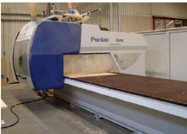
Die sieben NC-Fräsmaschinen bearbeiten die unterschiedlichen Komponenten. Durchschnittlich werden wöchentlich zwei Lastzug-Ladungen mit Sperrholz-Platten angeliefert.
