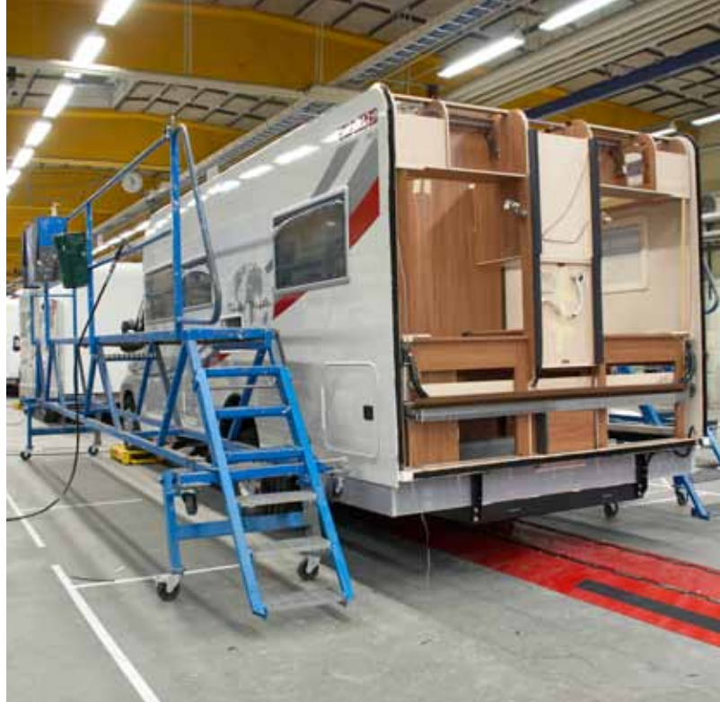
Den 102 meter lange motoriserte linjen gir plass til 10 biler og hastigheten bestemmes utifra etterspørselen.
