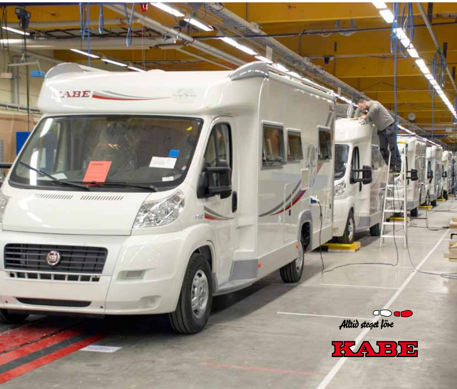
Bobilene bygges innenfra og ut og innredningen står ferdigmontert ved siden av linjen.
