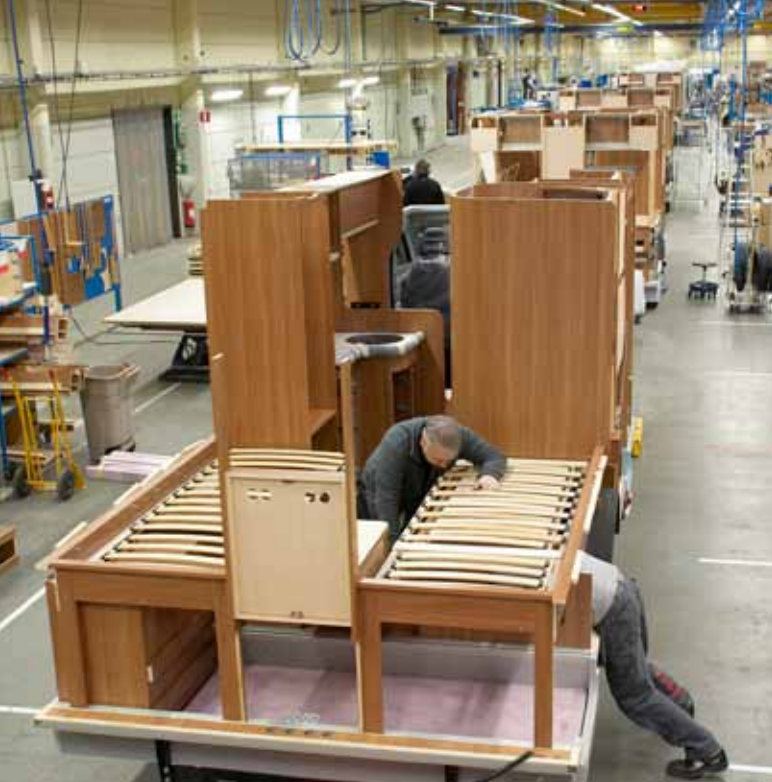
Bobilene bygges innenfra og ut og innredningen står ferdigmontert ved siden av linjen.
