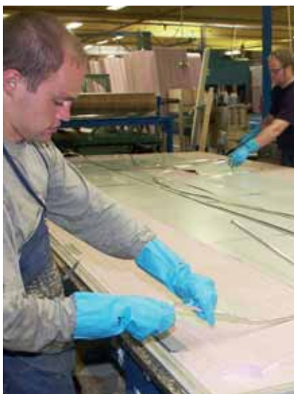
Försiktigt knackas rören ner i spåren.
